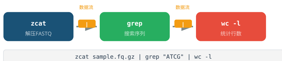
图 9-1 管道流水线示意：解压 → 搜索 → 计数，数据在命令间无缝传递
