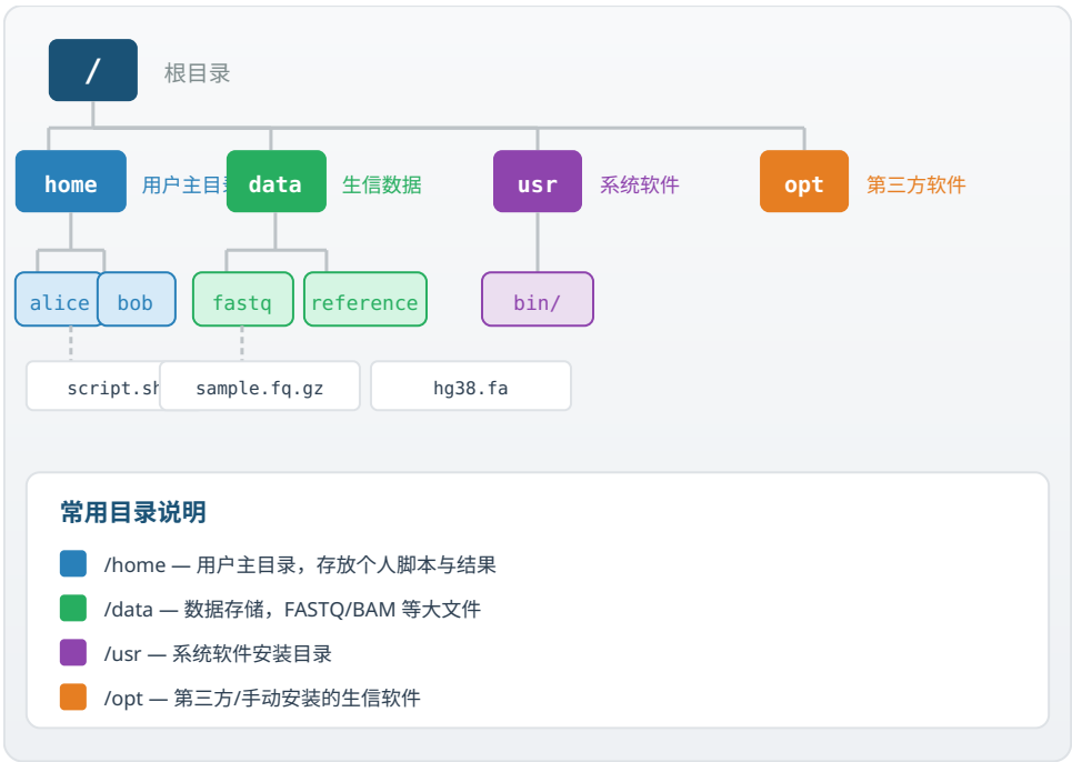
图 7-1 Linux 文件系统树状结构（不同颜色区分不同用途的目录）
